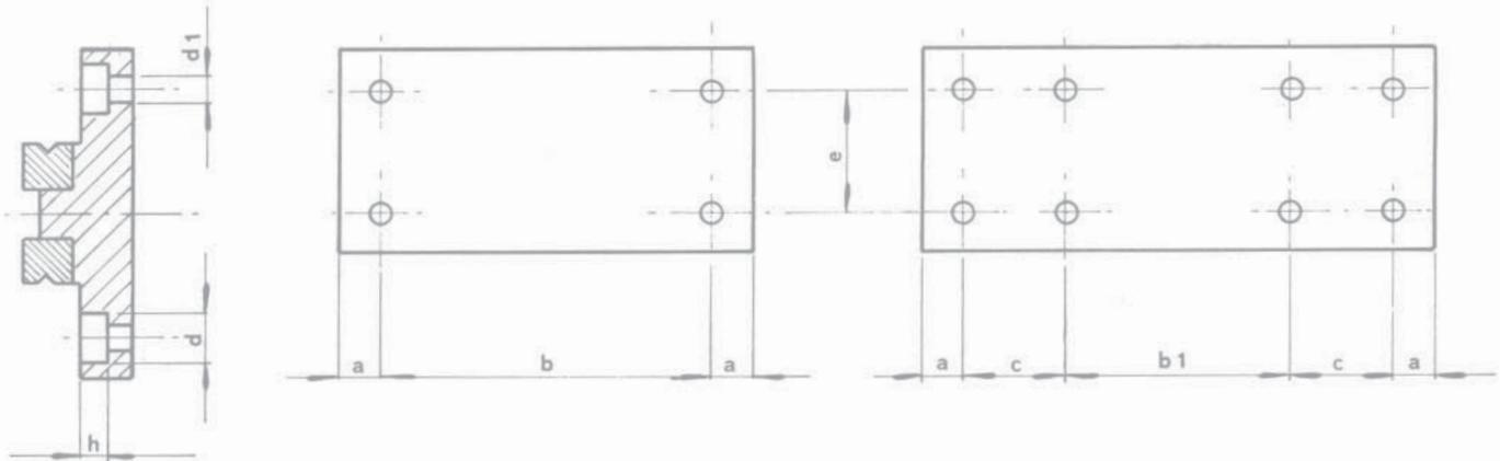
Le parallélisme des tables sur roulements appariées est respecté avec une tolérance de 0,01 mm (cote A-A1).
